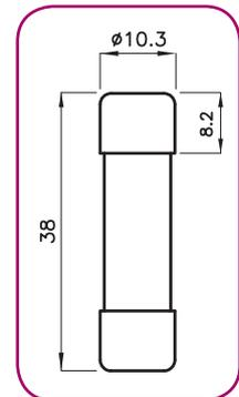
Предохранители TRB для защиты аккумуляторных батарей электрокаров
