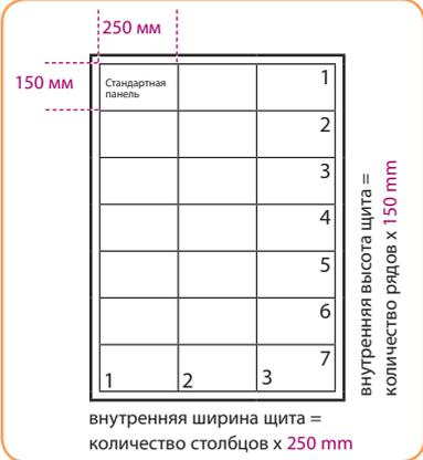
**Габаритные размеры щита наружной установки 4XN160 с опорным профилем WP-A**
