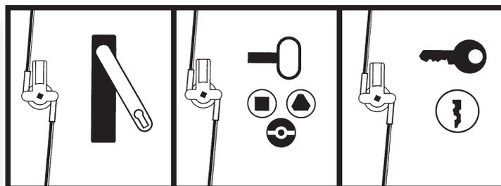
Дверца снимается, вставляется, регулируется без применения инструмента. Стандартные модели дверных ручек в настоящее время используют все запорные системы. Установленные на заводе толкатели замка с двойными дверями могут быть повторно использованы
