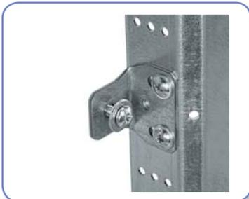
Служит для монтажа шин TH-35 или панелей PM к вертикальному опорному кронштейну WP-A. Крепится с помощью двух саморезов (AST 4.8x9.5) . В элементе LG-V имеется отверстие с резьбой М5. Шины TH-35 и монтажные панели крепятся к LG-V болтом М5 (AS-C 5x10) с шайбой (AW-RE5).
