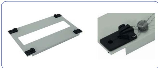
Заглушки CP изготавливаются из стального листа, покрашенного порошковой краской. Все заглушки оснащены заземляющей шпилькой ( в случае монтажа аппаратуры на заглушках, либо недостатка минимального расстояния изоляции необходимо заземление заглушек). Комплектно заглушка поставляется с крепежными задвижками. Задвижки имеют возможность пломбирования . Специальная конструкция задвижки позволяет монтировать заглушки очень быстро и просто.
