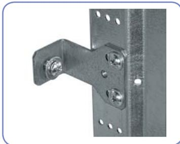
Служит для монтажа шин TH-S или панелей PM к вертикальному опорному кронштейну WP-A. Крепится с помощью двух саморезов (AST 4.8x9.5) . В элементе LG-V5 имеется отверстие с резьбой М5. Шины TH-35 и монтажные панели крепятся к LG-V5 болтом М5 (AS-C 5x10) с шайбой (AW-RE5) Позволяет применять оборудование на большей глубине, чем LG-V.
