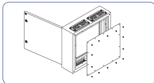
Задняя стенка исполнена из оцинкованного стального листа, монтируемого при помощи саморезов. Снятие задней стенки дает возможность подключения проводников к аппаратам, смонтированным на уже установленной внутренней части
