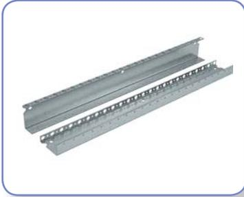
Бюджетная версия опор не позволяет разделять корпус на секции, и регулировать положение по-глубине монтажных шин TH-35 и панелей PM. Предусматривает монтаж модульных аппаратов с расстоянием от шины TH-S до заглушки аппаратов 48,5 мм
