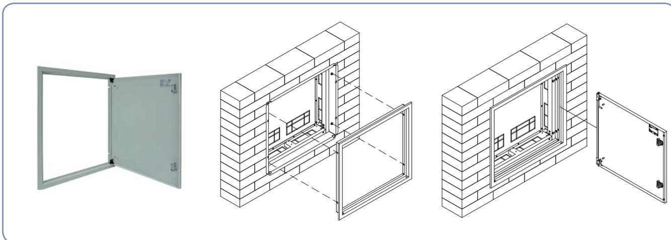
После всех монтажных работ к кассете крепится рамка с дверцей. Монтаж производится с помощью шурупов, есть возможность регулировки по вертикали около 20 мм. Существует возможность отклонения (несколько процентов) от плоскости стены, для исправления ошибок монтажа. Дверь можно переставлять с левой стороны на правую.
