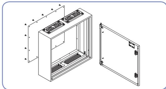
Щит наружной установки состоит из корпуса со съемной задней крышкой и сплошной дверцей.
