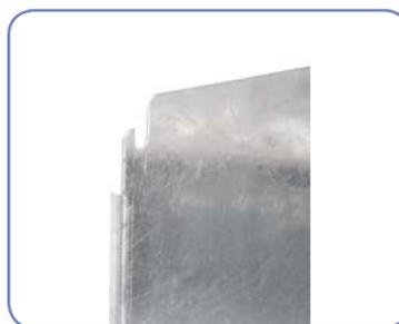
Монтажная панель изготовлена из стального оцинкованного листа толщиной 2 мм. В зависимости от размеров, панель может иметь изогнутые кромки для придания жесткости. Монтируется панель в корпусе на шпильки M8x25мм.
