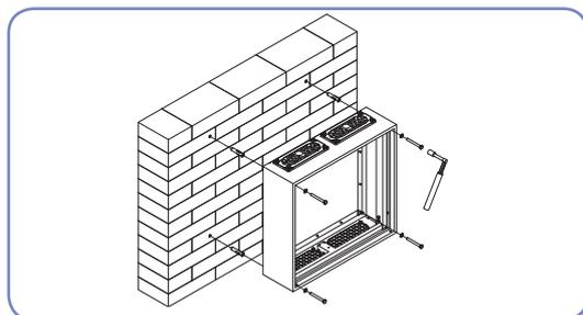
Такой тип монтажа не позволяет проводить демонтаж без открытия двери.
