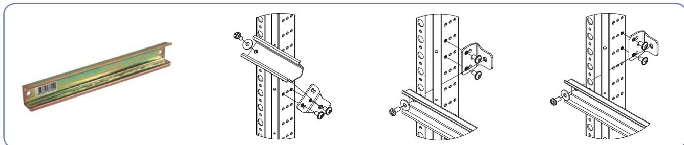
Монтаж шин TH-S возможен на разных расстояниях от лицевой панели( применяя элемент LG-V : минимальное расстояние-42,5 мм, стандартное- 48,5мм, максимальное- 64,5 мм; в случае применения LG-V5 минимальное расстояние составляет 70 мм, стандартное-76 мм, максимальное-92мм.) Возможен также монтаж шины под углом ок. 51 градус отклонения от вертикали. Это облегчает подключение проводников к клеммам, смонтированным на шине.
