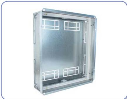
Изготовлена из листовой оцинкованной стали толщиной 1 мм. Имеет ослабления для выбора отверстий для прокладки кабелей и проводников. Имеет отверстия для монтажа в нише. Болты М6х40 которые поставляются комплектно служат только для позиционирования кассеты. Окончательный монтаж производится с помощью распорных дюбелей (в кассете отверстие диаметром 9мм) и монтажной пены (в кассете имеются отверстия для запуска пены).
