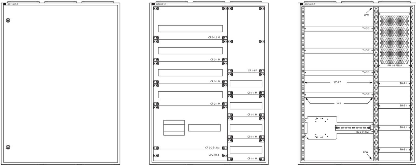
Настенный шкаф 4XN160 3-7 с кассетой для модульных аппаратов , разъемов NH00, выключателей EB / ED 125, 160, 250A
