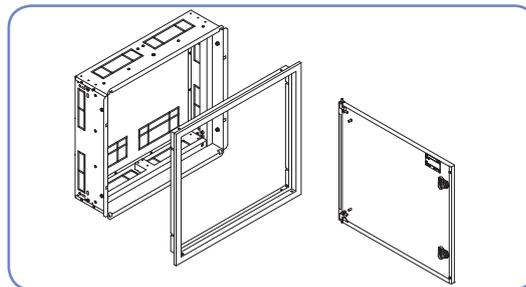
Щит внутренней установки состоит из кассеты и съемной рамки со сплошной дверцей.
