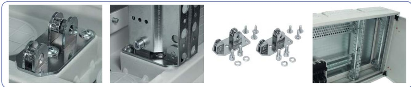
Важным преимуществом системы - это возможность разделения на секции с помощью комплекта EPW и вертикальных опорных кронштейнов WP-A. Это дает возможность разделить один корпус на части с разным назначением: силовоточные и слаботочные, телекоммуникационные и т.п. Комплект разделительный EPW состоит из : 2-х упоров, 6 саморезов, 4 болтов М6 и 4 шайб.
