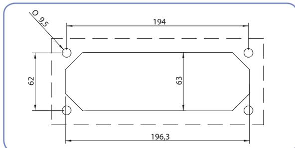
Внешние щиты имеют отверстия для прохода кабеля (стандарт FL21). В щите сверху стандартно установлены мембранные кабельные вводы ЕН-ТКС-36, а снизу в отверстиях установлены пластиковые заглушки. В случае нижнего подвода кабелей существует возможность переворота щита на 180. В дополнительном предложении можно найти мембранные, стальные и алюминиевые кабельные вводы.
