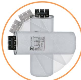
→ Возможность монтажа конденсаторных батарей как в вертикальном, так и в горизонтальном положении. При монтаже в горизонтальном положении необходимо обеспечить соответствующий уровень охлаждения и дополнительную механическую фиксацию конденсатора
