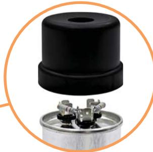
→ Для снятия остаточного напряжения все конденсаторные батареи оснащены разрядными резисторами (время разряда ≤ 3 минуты до 75 V)
