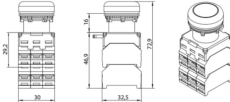
Четыре дополнительных контакта + модуль подсветки:
