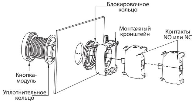
Монтаж моноблочных устройств
