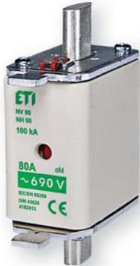
**Применение** - Ножевые предохранители с характеристикой aM предназначены для защиты цепей электродвигателей и устройств регулирования их мощности. Изготавливаются во всех стандартных типоразмерах со стандартными токами и напряжениями от 690V до 1000V. Ножевые предохранители с характеристикой aM защищают устройство только от токов короткого замыкания. Для защиты от токовых перегрузок необходимо использовать дополнительное оборудование.
