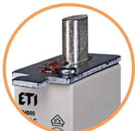
→ Корпус предохранителя выполнен из стеатита - термически устойчивого материала. Ножевые контакты изготавливаются из латуни с напылением серебра. Торцевые крышки выполнены из алюминия, что обеспечивает длительную защиту от коррозии. Корпус заполнен специальным кварцевым песком строго определенной грануляции, что гарантирует высокую отключающую способность и стабильность параметров защиты
