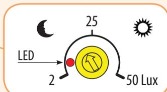
При срабатывании реле загорается красный LED
