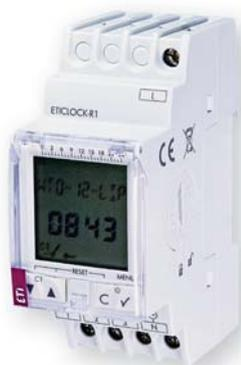
**Применение** - Служит для управления освещением, вентиляцией и прочими нагрузками. Основные функции: Вкл./Выкл. в определенное время, краткосрочные коммутации (от 1 до 59 секунд), повторяющиеся циклы (от 1 до 59 секунд или от 1 минуты до 23 часов 59 минут). **Программы** - суточная, недельная.
