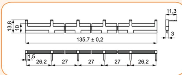
Описание: Предназначена для соединения цокольных реле ERB (до 6 цоколей). Шина соединяет общие сигналы входов (клеммы катушки A1 или A2). Максимальный допустимый ток 10 А / 250 V AC.
