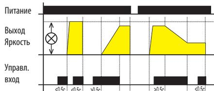
Кратким нажатием (<0.5с) светильник включится, последующим кратким нажатием - выключится. При длительном нажатии (>0.5 с) происходит плавная настройка уровня яркости. После отключения кнопки, уровень яркости будет занесен в память, а краткие нажатия включают/выключат светильник на этом уровне яркости. Изменять настройки можно продолжительным нажатием кнопки.
