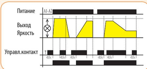
Кратким нажатием (<0.5 с) светильник включится, последующим кратким нажатием - выключится. При длительном нажатии (>0.5 с) происходит плавная настройка уровня яркости. После отключения кнопки, уровень яркости будет занесен в память, а краткое нажатие включит/выключит светильник на этом уровне яркости. Изменять настройки можно продолжительным нажатием кнопки. Длина управляющего импульса min. - 80мс, max. - не ограничена.
