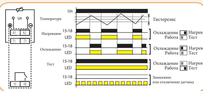
Реле представляет собой простой, но практичный термостат со съёмным датчиком для контроля температуры. Устройство можно разместить в распределителе, а датчик может измерять температуру помещения, предмета или жидкости. Питание гальванически не изолировано от датчика, исполнение последнего соответствует требованиям двойной изоляции. При повреждении или замыкании датчика,
