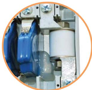
→ В системах заземления ТТ применяются ограничители с закрытым искровым разрядником. Искровой разрядник отделяет нейтральный проводник (N) от заземляющего (PE)
