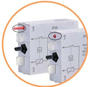
→ Механический шток визуальной и дистанционной сигнализации повреждения варистора и извлечения модуля (видимый – ОК, скрытый – повреждение)
