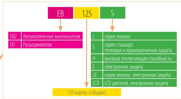
→ Определить модель и тип автоматического выключателя можно по маркировке на корпусе
