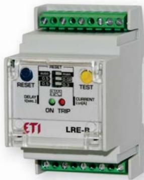
**Применение** - Реле LRE-A/-B используются совместно с внешними трансформаторами тока и применяются для контроля тока утечки на землю. Данные устройства разработаны для совместной работы с автоматическими выключателями серии ETIBREAK 2 оснащённых независимым ресцепителем. Функция выбора тока утечки и задержки отключения даёт возможность применять данные реле при построении схем селективности с использованием других реле утечки на землю или других устройств дифференциальной защиты.
