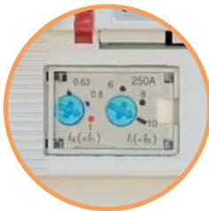
→ Автоматические выключатели серии ETIBREAK 2 имеют возможность регулировки как тепловой, так и электромагнитной защиты. Уровень защиты от перегрузки регулируется в диапазоне от 0,63 до 1 x I<sub>n</sub>. Настройка электромагнитной защиты осуществляется в диапазоне от 6 до 10 (12, 13) x I<sub>n</sub> для автоматических выключателей EB2 125-250 габаритов
