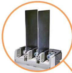
→ Для защиты от прикосновения к токоведущим частям есть несколько вариантов защитных крышек клемм (IP 20); разделительные перегородки обеспечивают максимальную изоляцию между клеммами АВ; корпус АВ имеет двойную изоляцию
