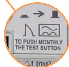
→ Тип A: для переменного и пульсирующего постоянного токов утечки
