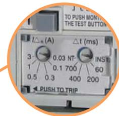
→ Регулируемый ток утечки в пределах 0,03А - 3А. Регулируемая задержка отключения при срабатывании защиты от утечки тока на землю в пределах 60ms - 700ms, включая функцию INST (мгновенное отключение) и NT (не отключает)
